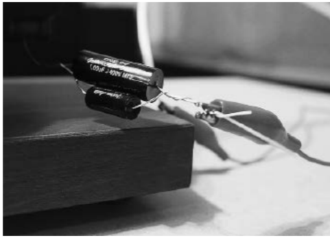
JBL2405とコンデンサを直列につないだ写真。ワニ口クリップを使い、容易に交換できるようにした
