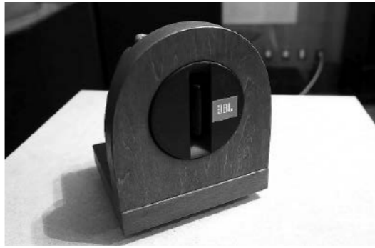
トゥイーターはJBLのホーントゥイーター2405（16Ω）を中古で入手。木製のスタンド付きだったのでそのまま利用することに
