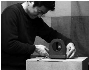
音源を再生しながら、トゥイーターを少しずつ後ろへ下げていくと、バッフルから12cm奥くらいでピタッとフォーカスが合った
