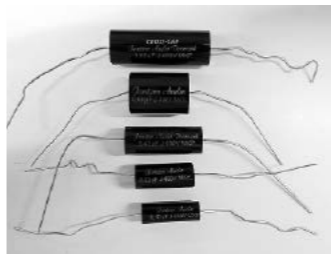
Jantzenのフィルムコンデンサ、0.1μF、0.22μF、0.47μF、0.68μF、1.0μFを秋葉原の海神無線で購入。右の計算式に当てはめると、カットオフ周波数（は0.47μFで21.2kHz、0.68μFで14.6kHz、1μFで9.9kHzとなる。0.1μF、0.22μFは微調整用に用意した
