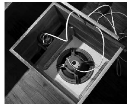
邪道スピーカー内部。平行面だらけだが、ここを対策するとどう変化するのか
