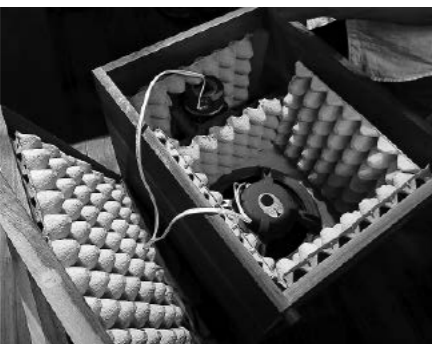
サイド、底板、天板と卵パックを全面に貼っていく
