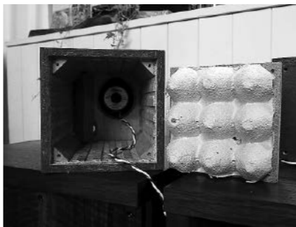
小型スピーカー最終版の内部。裏板は卵パック、サイドは凸凹にし平行面をなくし、空気抜き穴には、風切り音を遮蔽する柱を立てた。このスピーカーにより定在波の悪影響を知った
