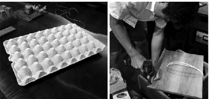
最終兵器卵パック。再生紙でできているため、音の癖も少なそう 三角の隅木を木ねじで固定し、スピーカーのコーナーを潰していく
